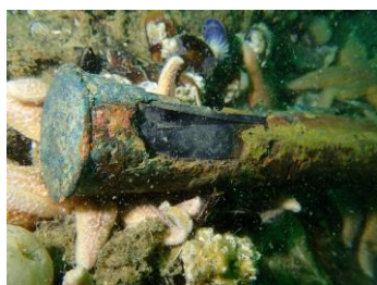
Fig.8 : douille déchirée, plaquettes de poudre visibles
